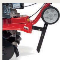
KÄÄNNETTYNÄ TOISINPÄIN, TANKO TOIMII SYVYYSMITTARINA T/205 JA T/245
