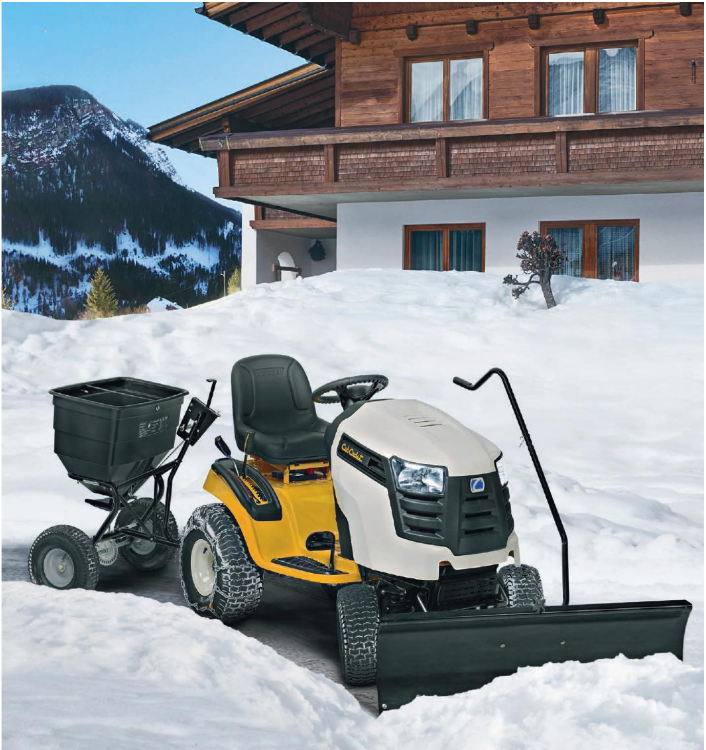
Ajoleikkurissa puskkulevy, levitin ja lumiketjut
